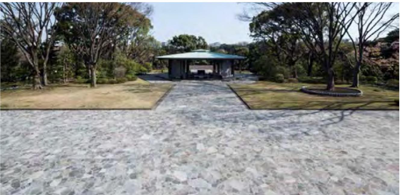
戦没者墓苑中央広場の既設敷石を撤去後、新規の鉄平石を 3 タイプの石材を組み合わせた乱張り舗装。
